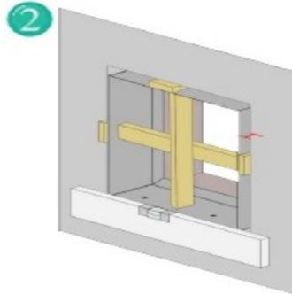
2 Nehmen Sie den äußeren Einbaurahmen und führen ihn von vorne in den Ausschnitt ein. Richten Sie den Rahmen mithilfe einer Wasserwaage gerade aus, fixieren Sie ihn mit Keilen und setzen Sie senkrechte und waagerechte Spreizen. Bitte beachten Sie dabei die Öffnungsrichtung:
