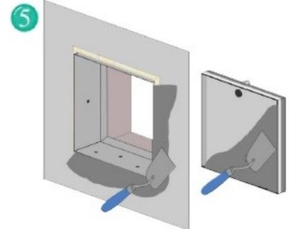
5 Spachteln/Verputzen Sie den umlaufenden Anschluss an die Massivwand und die Revisionsklappe. Wir empfehlen für die Klappe den Knauf Klebe- und Armiermörtel Aquapanel®
