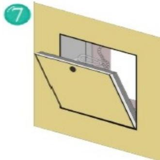
7 Tragen Sie einen Oberputz Außen auf. Wir empfehlen dazu entweder Dispersionsputz Aquapanel® oder Mineralischer Oberputz Aquapanel®. Setzen Sie das Türblatt mit den Alustiften auf der Unterseite in die vorbereiteten Bohrungen des Außenrahmens. Hängen Sie aus Sicherheitsgründen die Fangsicherung ein und schließen Sie die Revisionsklappe.
