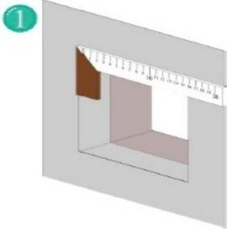
1 Prüfen Sie die Größe des Wand-Ausschnitts und der Revisionsklappe. (Rahmenaußenmaß der Klappe + 5mm) Beseitigen Sie Unebenheiten in der Einbau-Laibung.
