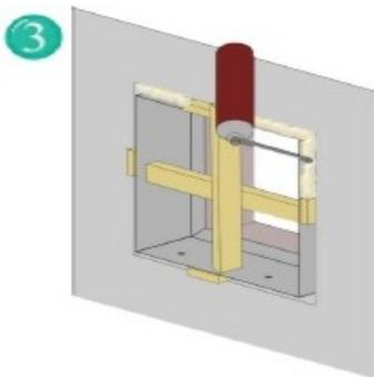
3 Füllen Sie den Spalt zwischen der Einbau-Laibung und dem Rahmen mit Montageschaum aus und lassen Sie ihn gemäß Herstellerangabe aushärten.
