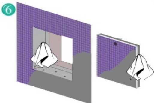
6 Verstärken Sie den Mörtel mit Verstärkungsgitter und putzen Sie dieses ein. Tragen Sie die Grundierung Außen Aquapanel® auf und säubern Sie den äußeren Einbaurahmen und den Alu-Rahmen der Revisionsklappe, so dass die Fuge frei von Rückständen ist. Dies ist besonders wichtig, damit die Funktion der Revisionsklappe nicht beeinträchtigt wird.
