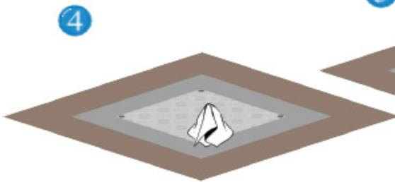
Hat der Beton ca. 80 % seiner Festigkeit erreicht, reinigen Sie die sichtbaren Flächen der Schachtabdeckung.
