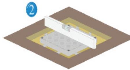
Setzen Sie die zusammengebaute Schachtabdeckung in die Aussparung am Boden und richten Sie sie flächenbündig auf die Höhe des Endbodenbelags aus. Es sollten umlaufend mindestens 100 mm Platz zum Ausbetonieren sein.
