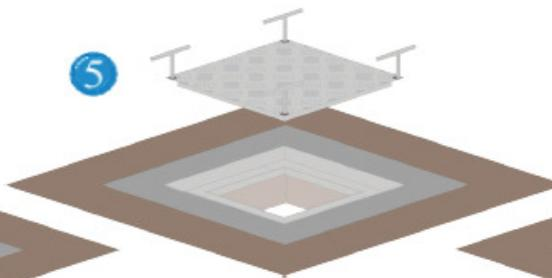
Nach dem vollständigen Aushärten entfernen Sie bitte die Abdeckkappen und die Schrauben. Schrauben Sie die vier Hebeschlüssel in die Gewinde in den Hebepunkten. Jetzt können Sie den Deckel aus dem Rahmen herausnehmen.
