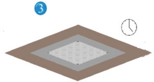
Betonieren Sie die Schachtabdeckung umlaufend vollständig oder bis zur Unterkante des Endbodenbelags ein. Schützen Sie die Schrauben und Ränder vor Betonspritzern. Lassen Sie den Beton vollständig aushärten. Sobald der Rahmen eine feste Verbindung mit dem Beton hat, kann die Schachtabdeckung nicht mehr verrutschen.
