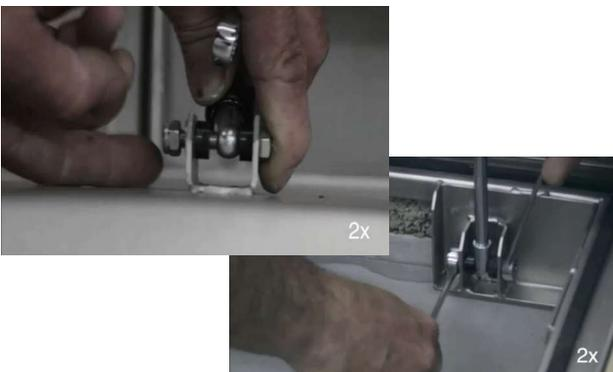
Entfernen Sie den Warnhinweis an der unteren Halterung der Gasdruckfedern und bringen Sie die Gasdruckfedern an der oberen und unteren Halterung an. Der schwarze Zylinder muss sich dabei oben befinden.
