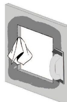
Putzen Sie bitte die beiden Alu-Rahmen der Revisionsklappe sauber ab. Dies ist besonders wichtig, damit die Funktion der Revisionsklappe nicht beeinträchtigt wird. Schleifen Sie nach dem Trocknen Unebenheiten ab.
