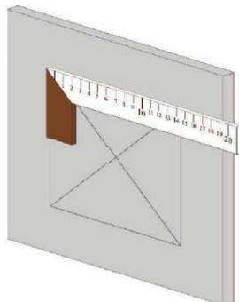
Bitte zeichnen Sie mithilfe eines rechten Winkels den Einbau-Ausschnitt an der Gipskartonwand/-decke an. (Bestellmaß + 5mm)
