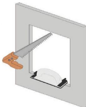
Schneiden Sie den Einbau-Ausschnitt nun aus. (Stichsäge, Fuchsschwanz...) Bitte achten Sie drauf, dass die Kanten gerade und frei von Rückständen sind.
