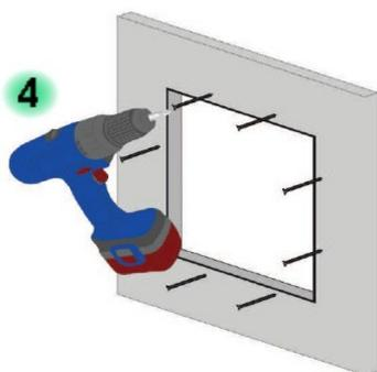
Drücken Sie den Rahmen von hinten an die Wand-/Deckenplatte. Nun verschrauben Sie den äußeren Einbaurahmen mit Bohrkopfschrauben im Abstand von max. 17cm an der Gipskartonwand/-decke.
