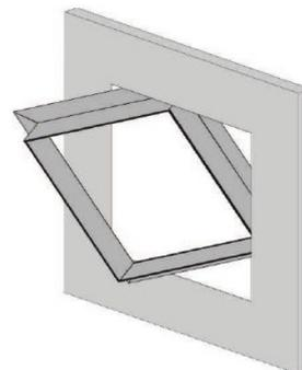
Nehmen Sie das Türblatt aus dem Außenrahmen und führen Sie diesen durch die Öffnung in den Wand-/Deckenhohlraum. Bitte beachten Sie bei Wandeinbau die Öffnungsrichtung: Die Schnappverschlüsse müssen sich oben befinden.
