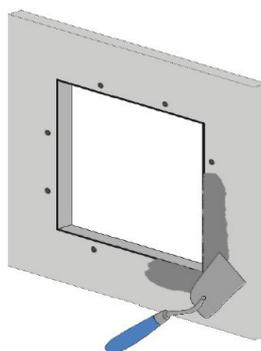
Spachteln Sie jetzt bei beiden Rahmen den umlaufenden Anschluss an die Gipskartonbeplankung inkl. der Schrauben.
