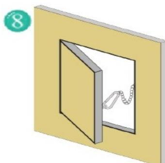
8 Hängen Sie aus Sicherheitsgründen die Fangsicherung ein und schließen Sie die Revisionsklappe. Bitte beachten Sie dies auch nach jedem Öffnen der Revisionsklappe.
