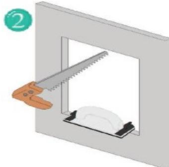
2 Schneiden Sie den Einbau-Ausschnitt nun aus. (Stichsäge, Fuchsschwanz...) Bitte achten Sie darauf, dass die Kanten gerade und frei von Rückständen sind.
