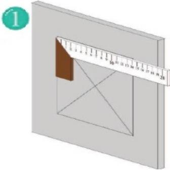
1 Bitte zeichnen Sie mithilfe eines rechten Winkels den Einbau-Ausschnitt an der Gipskartonwand/-decke an. (Bestellmaß + 5mm)
