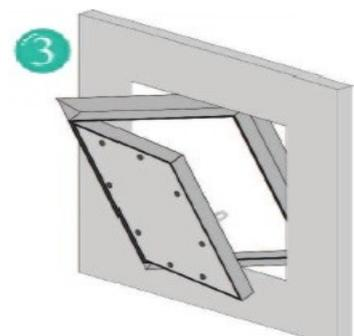
3 Führen Sie die Revisionsklappe durch die Öffnung in den Wand-/Deckenhohlraum. Bitte beachten Sie bei Wandeinbau die Öffnungsrichtung: Die Schnappverschlüsse müssen sich seitlich befinden.
