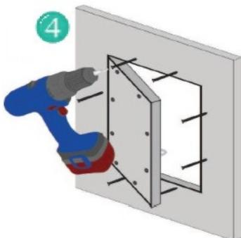
4 Drücken Sie den Rahmen hinten an die Wand-/Deckenplatte. Nun verschrauben Sie den äußeren Einbaurahmen mit Bohrkopfschrauben im Abstand von max. 17cm an der Gipskartonwand/-decke.
