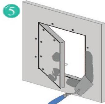
5 Spachteln Sie jetzt bei beiden Rahmen den umlaufenden Anschluss an die Gipskartonbeplankung inkl. der Schrauben.
