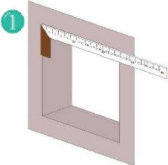
1 Prüfen Sie die Größe des Wand-Ausschnitts und der Revisionsklappe. (Rahmenaußenmaß der Klappe + 5mm)
