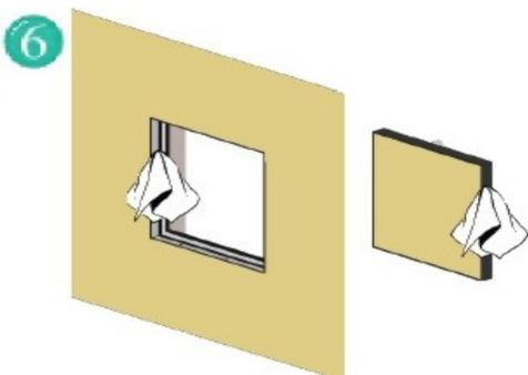
6 Putzen Sie den äußeren Einbaurahmen und den Alu-Rahmen der Revisionsklappe nach dem Spachteln und auch nach dem Streichen, so dass die Fuge frei von Rückständen ist. Dies ist besonders wichtig, damit die Funktion der Revisionsklappe nicht beeinträchtigt wird.
