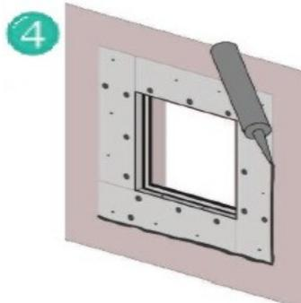
4 Schließen Sie die umlaufenden Fuge zwischen Revisionsklappe und Massivwand mit Brandschutzkitt oder Brandschutzmörtel (nicht im Lieferumfang).
