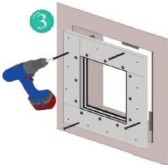
3 Nehmen Sie den äußeren Einbaurahmen und führen ihn von vorne in den Ausschnitt ein. Bitte beachten Sie dabei die Öffnungsrichtung: Die Schnappverschlüsse müssen sich oben befinden. Drücken Sie den äußeren Einbaurahmen an die Mauerwerkslaschen. Schrauben Sie ihn von der Sichtseite fest.
