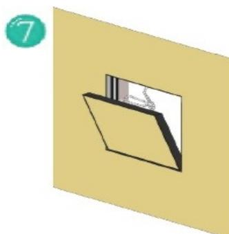
7 Setzen Sie das Türblatt mit den Alustiften auf der Unterseite in die vorbereiteten Bohrungen des Außenrahmens. Hängen Sie aus Sicherheitsgründen die Fangsicherung ein und schließen Sie die Revisionsklappe.
