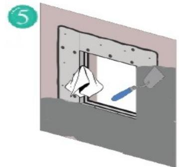
5 Spachteln/Verputzen Sie den umlaufenden Anschluss an die Massivwand und die Revisionsklappe.
